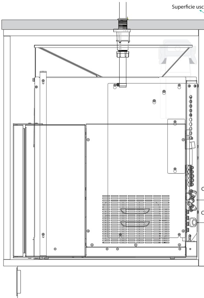
Superficie uscita aria ventilata  $12 \frac{2}{5} \text{ in}^2$  ( $80 \text{ cm}^2$ )
