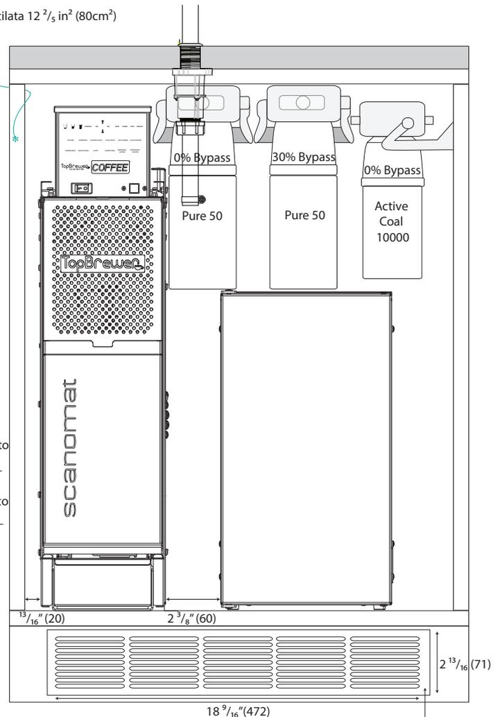
Superficie ingresso aria raffreddamento ~~Superficie ingresso aria ventilazione~~  $12 \frac{2}{5} \text{ in}^2$  ( $80 \text{ cm}^2$ )
