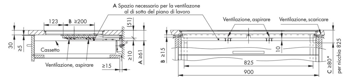
B Spazio necessario nelle pareti laterali a destra e a sinistra per la ventilazione dell'apparecchio
