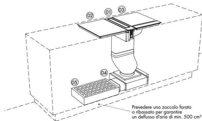
Piano cottura ed elementi canalizzazione
