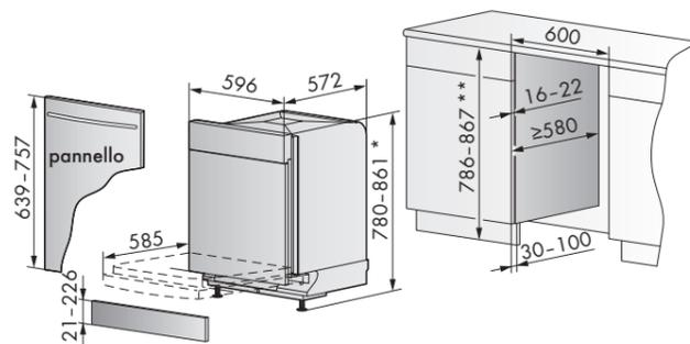
\* max 896 mm se viene utilizzata anche la seconda base di supporto grigia
