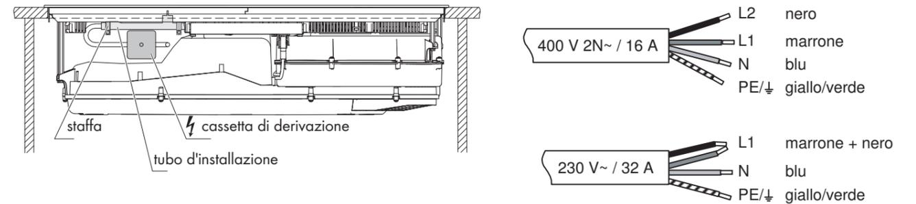
Apparecchio dotato di cavo di collegamento che deve essere allacciato a una cassetta di derivazione.
