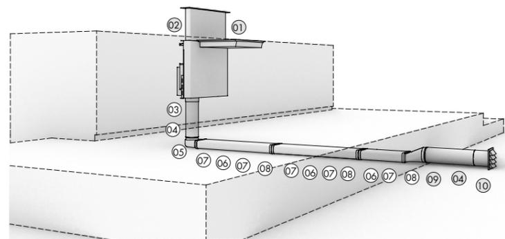
Piano cottura ed elementi canalizzazione
