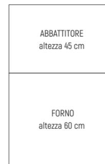
Attenzione allo spessore porta abbattitore e porta forno: nelle installazioni a colonna bisogna inserire, dietro il forno V-ZUG, un profilo di 2/3 mm di spessore per allineare il forno all'abbattitore. Per un allineamento perfetto bisogna quindi aumentare profondità del forno di 2/3 mm
