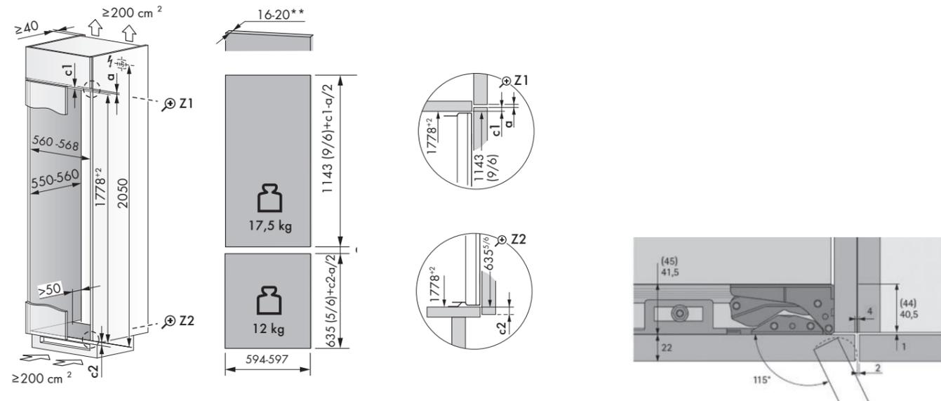
È possibile anche realizzare un unico pannello: in tal caso si avrà accesso ai due compartimenti (frigo e freezer) simultaneamente; nel caso in cui si voglia accedere separatamente ai reparti ordinare l'apposito profilo inox (KV4000L o KV4000R), peso massimo pannello unico 29,5 Kg.
