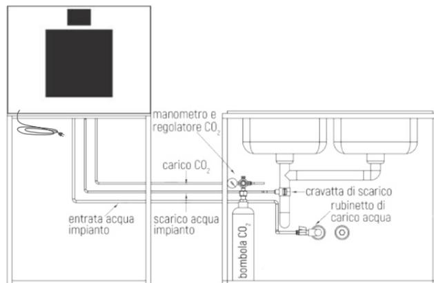
Nota bene: la pressione dell'acqua di ingresso non deve essere superiore a 5 bar e non inferiore a 1,5 bar. In caso di pressione di rete superiore a 5 bar applicare un riduttore di pressione acqua.
