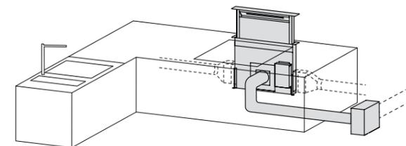
Il motore può essere installato in posizione remota interna (max 4 m di distanza dalla cappa) e non può essere installato all'esterno.
