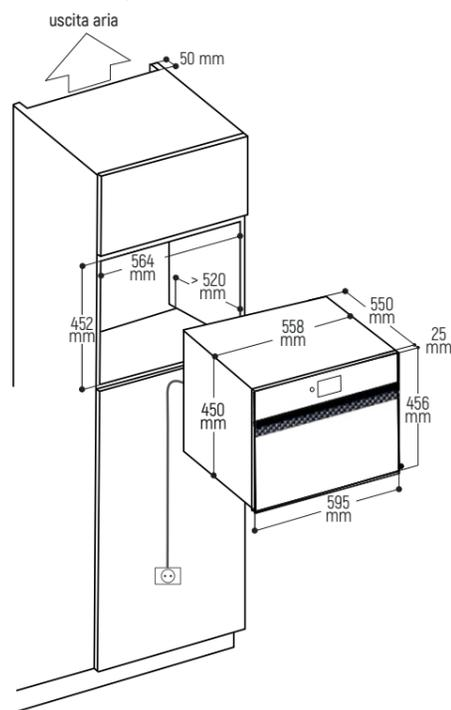
\*Spessore anta abbattitore: verificare lo spessore dell'anta del mobile adiacente per avere lo stesso allineamento.
