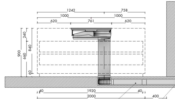
tubazioni nel massetto: prevedere sopra alle tubazioni un rinforzo per compensare i carichi; se le tubazioni usate sono in acciaio non serve il rinforzo.
