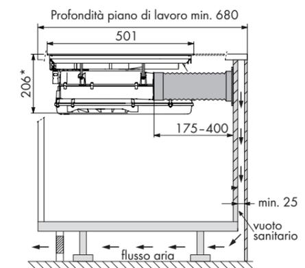
Dimensioni di ingombro con profondità base min. 600 mm
