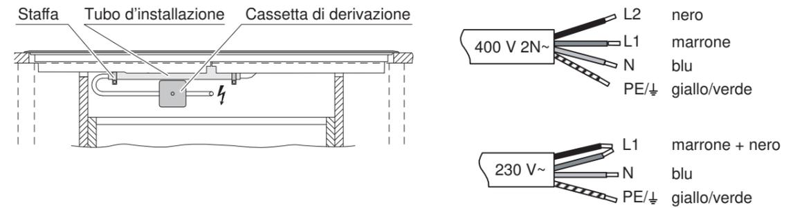
Apparecchio dotato di cavo di collegamento che deve essere allacciato a una cassetta di derivazione.
