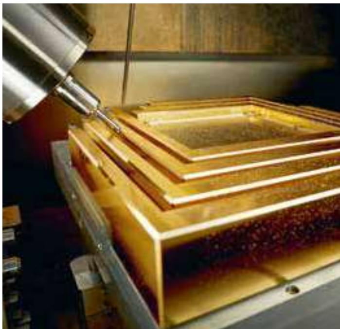
Le sfaccettature vengono fresate con un angolo esatto di 45° e si incrociano con assoluta precisione, creando una superficie priva di irregolarità. Tutto per ottenere una perfetta riflessione della luce. Gli standard per verificare il livello di brillantezza durante il controllo qualità, ridefiniti appositamente per questa collezione, garantiscono il rispetto di questi elevati requisiti.
