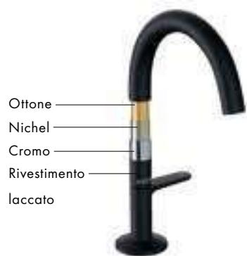
Il cromo è lo standard per le superfici degli ambienti sanitari e da decenni è un elemento intramontabile nel bagno. Attraverso la deposizione elettrochimica di vari metalli e a seconda del tipo di substrato, sul corpo di base in ottone immerso nel bagno galvanico si forma uno strato di rame, seguito da uno strato brillante di nichel e cromo.
