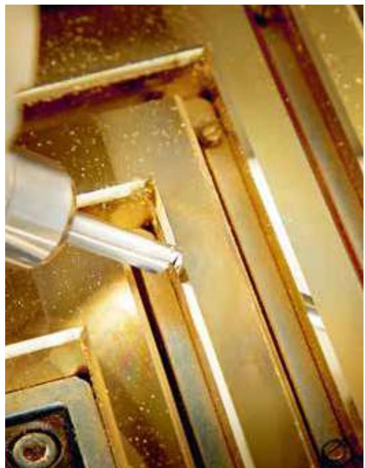
Utilizzando una punta di diamante si ottiene una brillante sfaccettatura con un angolo preciso di 45°.
